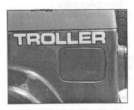
A tampa do tanque de combustível está localizada à esquerda do veiculo na parte traseira, protegida por uma portinhola. Gire a chave no sentido anti-horário para destravar a tampa, e no sentido horário para travá-la.
